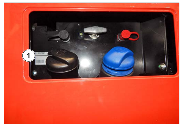
Figure 121: Remplissage du réservoir de carburant
